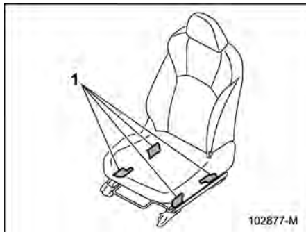
1 Capteurs de détection de présence d'un passager
